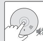
Stummschalt-Taste zur Unterdrückung des Alarmsignals.
